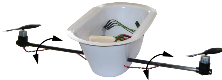
ABBILDUNG 2.1: Die Gondel ist mit zwei um 180° schwenkbaren Propellern versehen.
